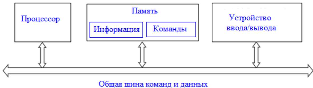
Рис.2. Архитектура с общей шиной данных и команд
