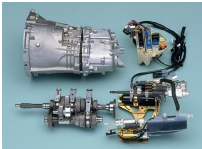
2-rasm. Avtomatik boshqariladigan mexanik uzatmalar qutisi
